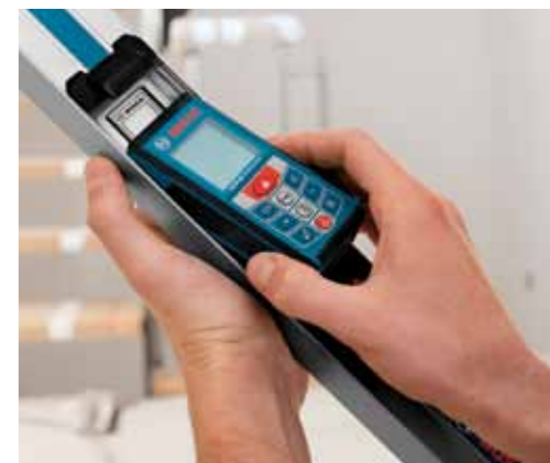
Eingeklickt in die dafür entwickelte Mess-Schiene R 60 Professional wird der GLM 80 Professional zur digitalen Wasserwaage. Die integrierte Schienenerkennung sorgt dafür, dass das Gerät beim Einschalten automatisch in den Neigungs-Messmodus wechselt und sich das Display dreht.
