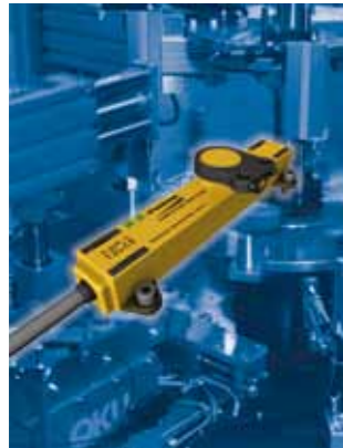
In die kleinste Nische passen die induktiven Wegsensoren der neuen LI-Q17-Serie, die dank eines Oszillators im Positionsgeber unempfindlich gegen elektromagnetische Störungen sind.
