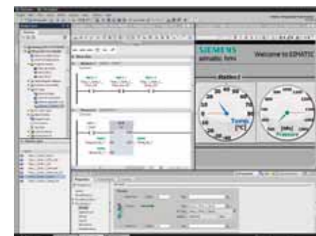
Alles im Blick – auf einem Screen: Anwenderprogramm und HMI-Projektierung
